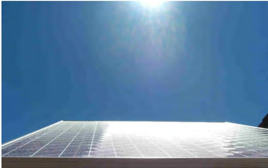
Einstrahlwinkel ca. 20°, Blickwinkel ca. 4°, Leuchtdichte des Hauptreflexes ca. 230.000cd/m<sup>2</sup>,
